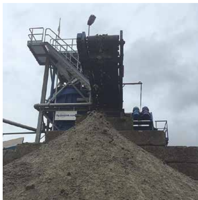
Reiniging van zand door middel van opstrooming in een waterkolom.
